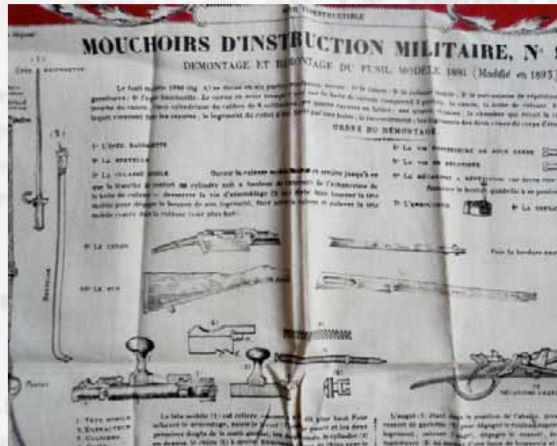
Mouchoir d'instruction militaire n°9, démontage et remontage du fusil modèle 1886, collection J. Camus
